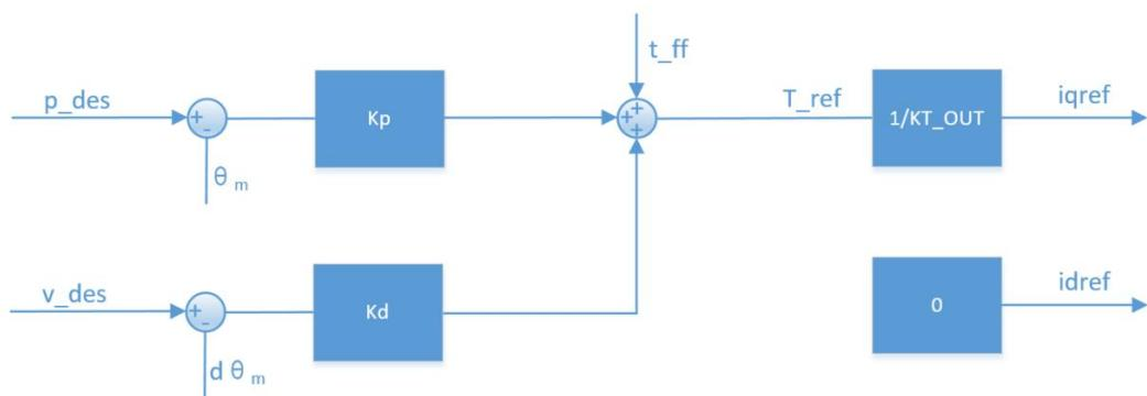
根据 MIT 模式可以衍生出多种控制模式，如  $kp=0, kd$  不为 0 时，给定  $v_{des}$  即可实现匀速转动； $kp=0, kd=0$ ，给定  $t_{ff}$  即可实现给定扭矩输出。
