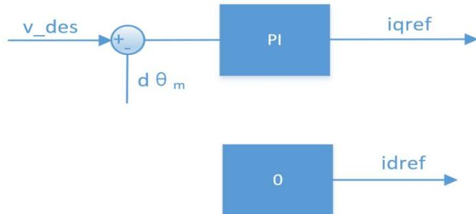
注意:  $v_{des}$  单位为  $rad/s$ , 数据类型为  $float$ , 如需使用调试助手自动计算参数, 则需要设置阻尼因子为非 0 正数, 通常情况下取值在 2.0~10.0, 过小的阻尼因子会带来速度的震荡以及较大的过冲, 过大的阻尼因子则会带来较长的上升时间, 推荐的设定值为 4.0。
