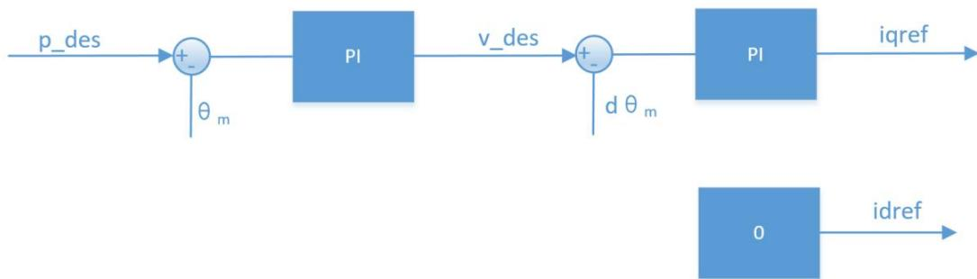
$p_{des}$  为控制的目标位置， $v_{des}$  是用来限定运动过程中的最大绝对速度值。
