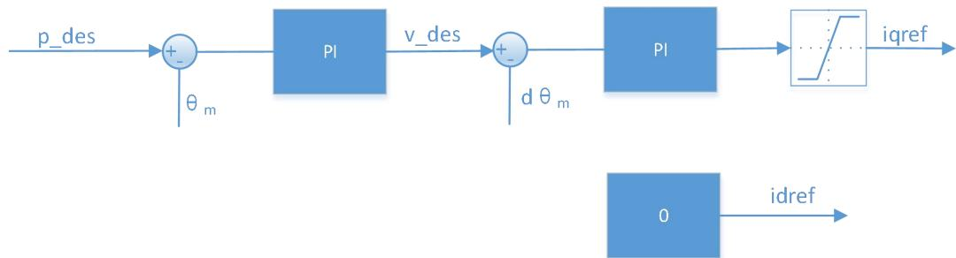
在速度环的输出指令后增加了电流指令饱和环节, 使得电流环的给定限定在给定范围内。
