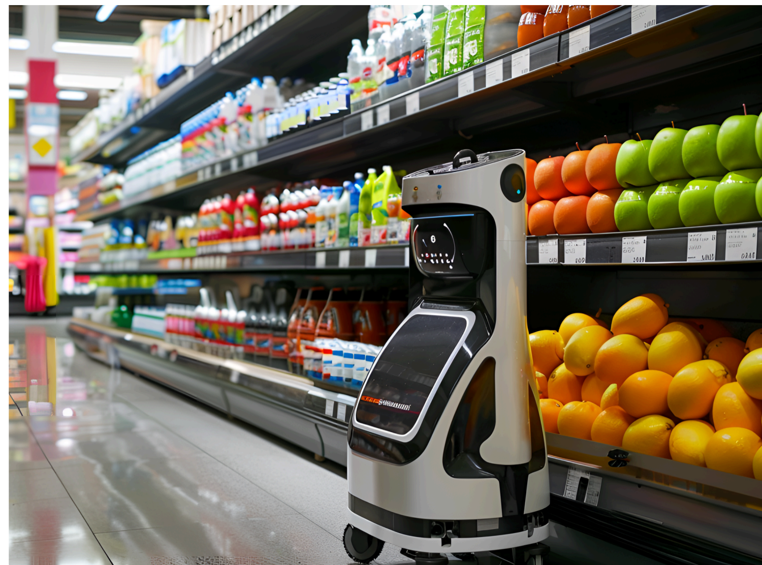
棚点検ロボット
